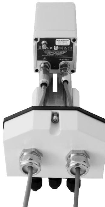
Schieben Sie den Schlitten in das Innere des Gehäuses bei Führung durch das Schienensystem.
