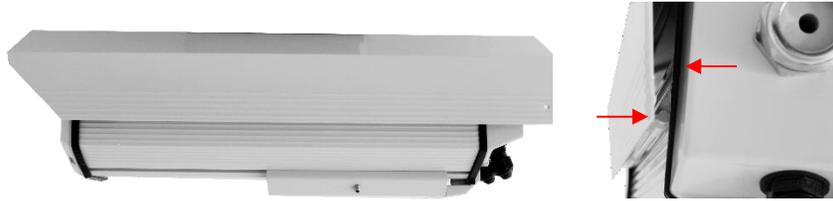
Drücken Sie den Gehäusedeckel nach oben bis die Feder am Gehäusedeckel in die Nut des Gehäusekörpers einrastet.
