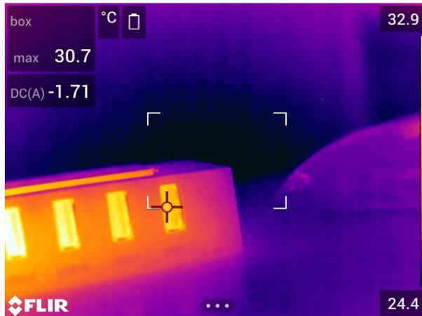
Im Vorschaumodus und beim Bearbeiten eines Bildes im Archiv können Sie mehr als einen Wert aus demselben FLIR-Messgerät hinzufügen. Der zuletzt hinzugefügte Wert wird unter den vorherigen Werten angezeigt. Der Livewert wird mit einer gepunkteten Umrandung angezeigt.
