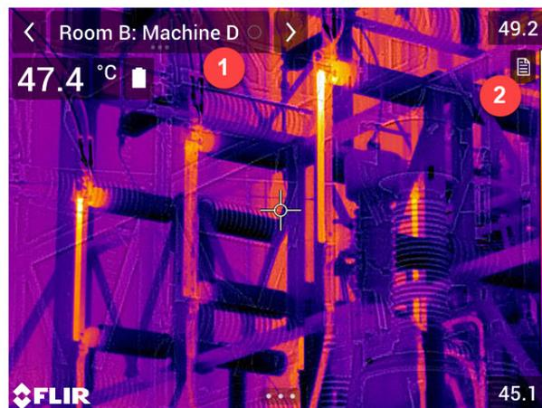
1. Die Anzeige des aktuellen Punkts zeigt an, welcher Prüfpunkt zu prüfen ist.
