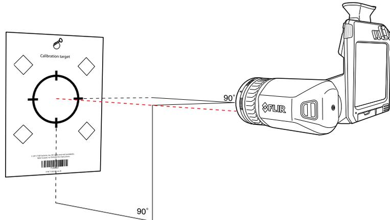
5. Richten Sie in der Kamera das Wärmebild und das Tageslichtbild (dargestellt durch zwei Quadrate in der Abbildung unten) mit den Pfeilen des Touchscreens aneinander aus. Die Objektiv-Kamera-Kombination ist jetzt kalibriert.
