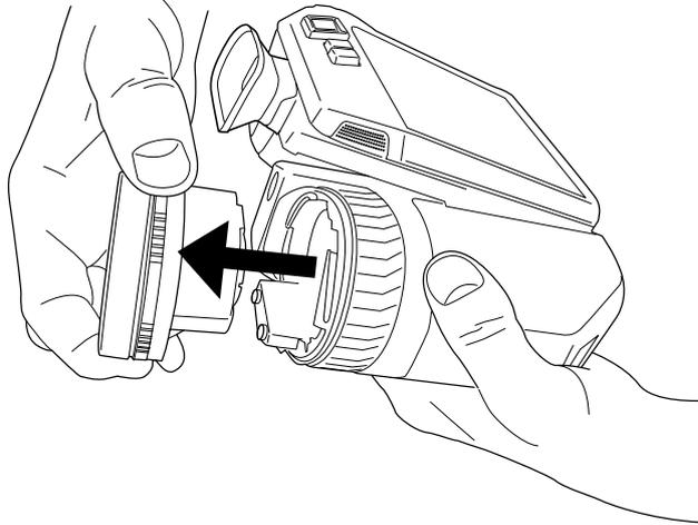
3. Der Infrarotdetektor ist jetzt vollständig belichtet. Berühren Sie diese Oberfläche nicht. Wenn Sie Staub auf dem Detektor sehen, befolgen Sie die Anweisungen in [23.3 Infrarotdetektor](#).
