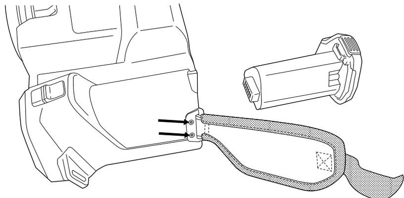
4. Lösen Sie die Trageschleife von der Halterung an der Unterseite der Kamera.
