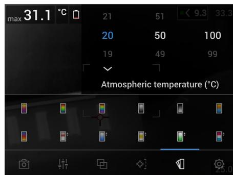
Für den *Wärmedämmungsalarm* können die folgenden Parameter festgelegt werden:
