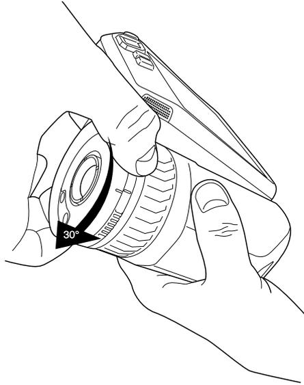
7. Vergewissern Sie sich, dass die beiden Markierungen aufeinander ausgerichtet sind und damit anzeigen, dass das Objektiv eingerastet ist.
