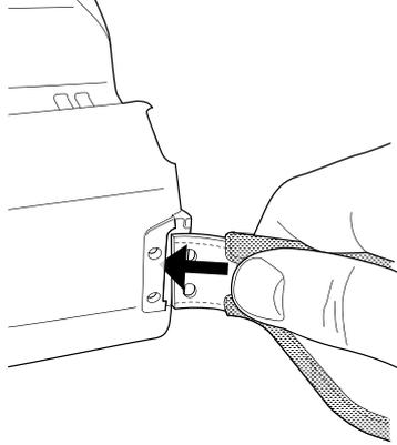
6. Schieben Sie die Halterung in die Kamera. Achten Sie darauf, dass die beiden Öffnungen in der Trageschleife und die Öffnungen in der Halterung übereinander liegen.
