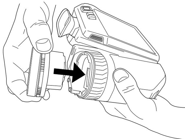
6. Drehen Sie den inneren Ring um 30° im Uhrzeigersinn. Wenn das Objektiv einrastet, ist ein deutliches Klickgeräusch hörbar.
