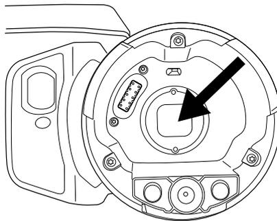
4. Vergewissern Sie sich, dass der innere Ring des Kameraobjektivs sich in vollständig geöffneter Position befindet.
