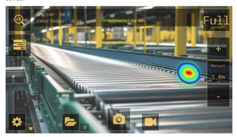
Kontinuierlicher Verschleiß von wichtigen Bauteilen in Förderanlagen kann zu einer Beeinträchtigung führen. Lager, die geschmiert werden müssen oder Fehler entwickeln, beginnen übermäßigen Schall zu erzeugen.
