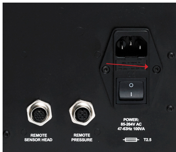
Abbildung 24 Austausch der Netzspannungssicherung
