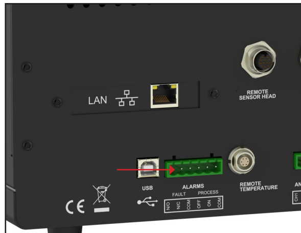
Abbildung 5 Anschlüsse für Alarmausgänge
