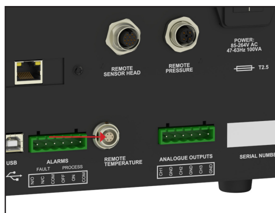
Abbildung 7 Anschluss des Remote-Temperaturfühlers
