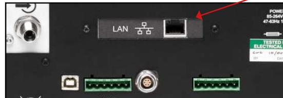
Abbildung 12 Ethernet-Anschluss
