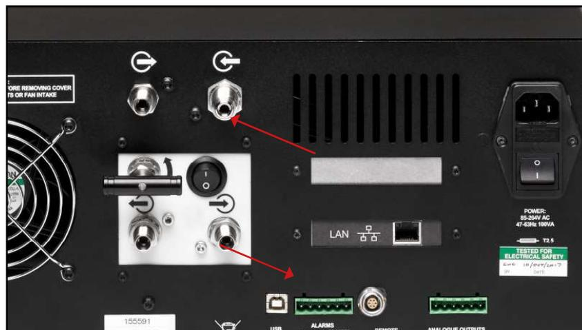
Abbildung 15 Gasanschlüsse bei Verwendung einer Pumpe
