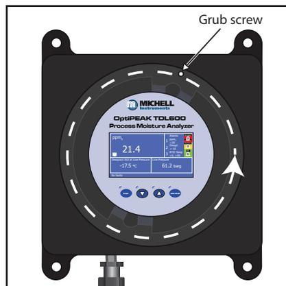
4. Entfernen Sie die blaue, runde Leiterplatte am Display, indem Sie die zwei PANEX-Verschlüsse an den Display-Halterungen lösen.
