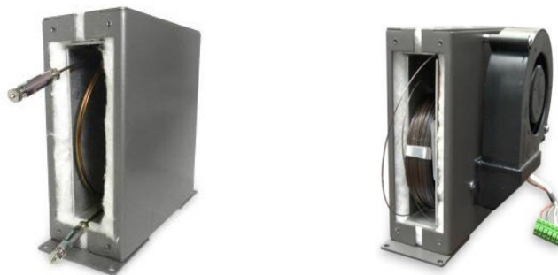
Abbildung 13: Isothermischer und programmierbarer Ofen
