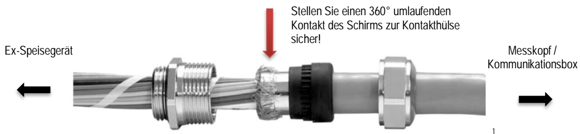
Abbildung 47: EMV gerechter Anschluss eines Kabels für Messköpfe und Kommunikationsbox
