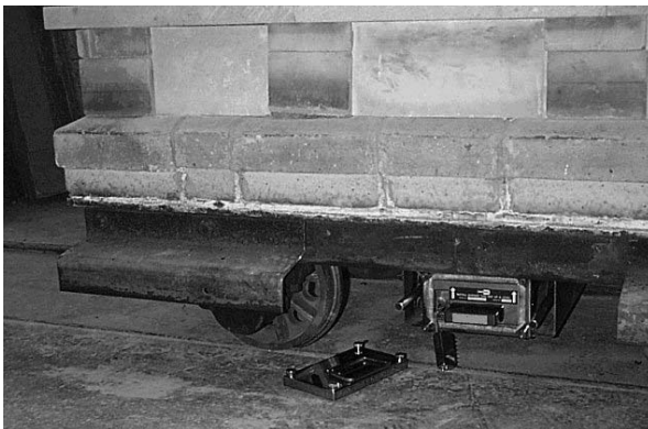
Befestigter Hitzeschutzbehälter an der Unterseite des Ofenwagens; ein Teil der „Seitenverkleidung“ wurde für die Anbringung entfernt
