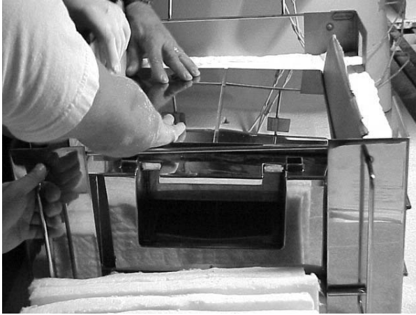
Hitzeschutzbehälter in dem mit Isoliermaterial auskleideten Kasten legen
