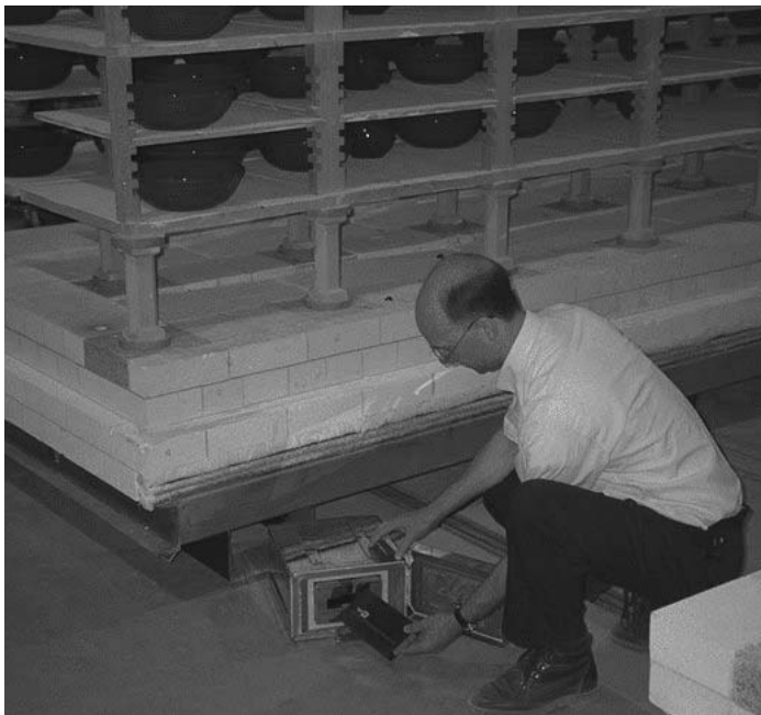
Datenlogger beim Einbringen in den Hitzeschutzbehälter
