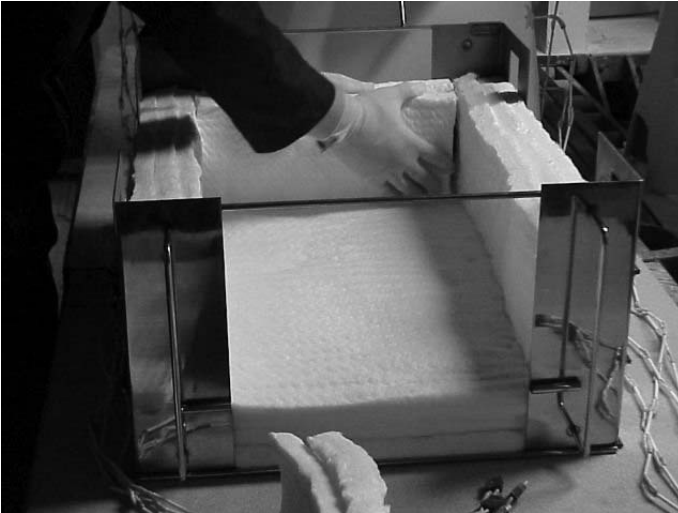
Kasten mit Isoliermaterial auslegen
