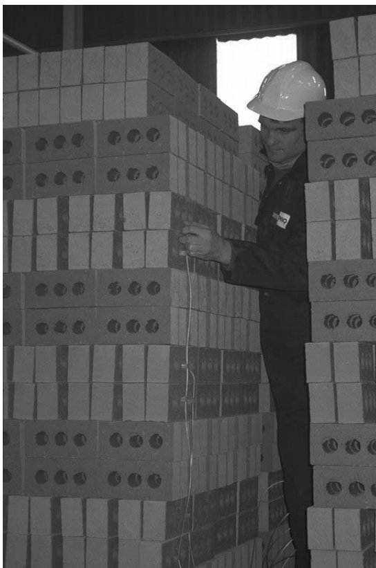
Vorbereitetes Kiln-Tracker-System zur Überwachung eines Ziegelbrands
