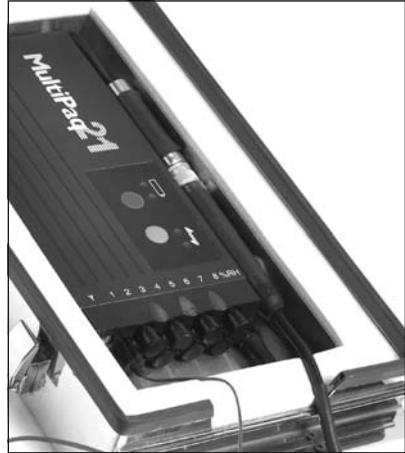
*Sensorelektronik in der Halterung innerhalb des Hitzeschutzbehälters.*
