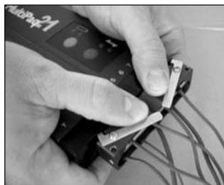
Um die Leiste vom Logger **abzuziehen**, schieben Sie zunächst die Hebel leicht nach vorne und ziehen dann vorsichtig an der Leiste. Die Stecker können Sie in der Leiste belassen, um die Thermoelemente für folgende Durchläufe schnell und einfach am Logger anzuschließen.
