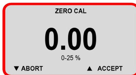
*Abbildung 17. Anzeige für die Kalibrierung des Nullpunkts*
