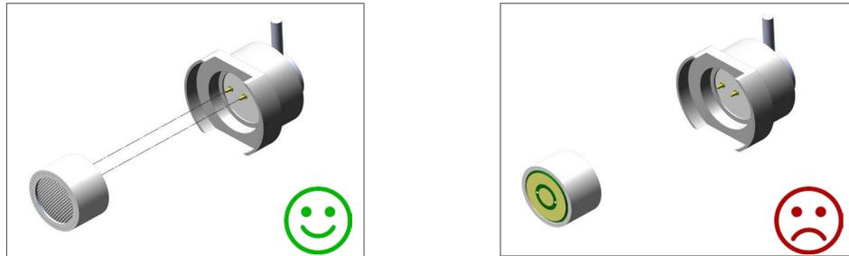
Abbildung 5. Ausrichten des Sensors
