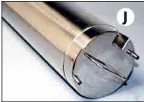
**8** Legen Sie die vorgeschneittenen **Isolierscheiben in den Behälterdeckel** ein und führen Sie die Thermoelemente durch die Öffnung im Deckel. Fetten Sie die Befestigungsbolzen am Deckel mit temperaturbeständigem Molykote-Schmiermittel ein und **setzen Sie den Deckel auf (J)**. Ziehen Sie die Muttern nicht zu fest an.
