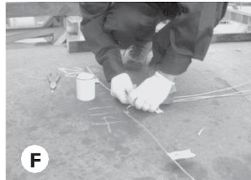
Plattenausschnitt (**F**) zurück: Verlegen Sie es innerhalb der bearbeiteten Rinne (wenn es durch Stahlblöcke geschützt werden soll) oder in einer geraden Linie entlang der Plattenoberseite (wenn Winkeleisen als Schutz verwendet werden soll); siehe [Schutz der Thermoelemente](#), Seite 23. Binden Sie die Thermoelemente entlang der Mittellinie der Platte vorübergehend mit Draht oder Klebeband zusammen.
