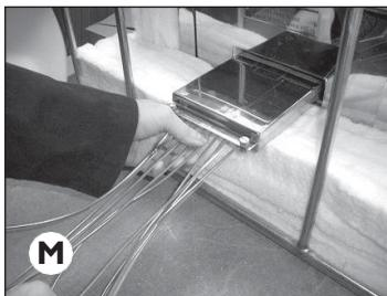
Führen Sie die innere Barriere (mit dem Logger) und die Thermoelemente in den Hohlraum der Wasserbarriere und schieben Sie sie bis zum Anschlag hinein (**M**). Versuchen Sie zu vermeiden, dass sich die Thermoelemente beim Austritt aus der Öffnung der Wasserbarriere zusammenballen.
