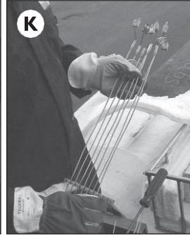
Thermoelements entfernt. Ziehen Sie die Schraube an, um das Thermoelement in seiner Position zu fixieren. Wiederholen Sie dies der Reihe nach, bis sich alle Thermopaare in der Klemme befinden (K).
