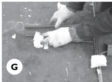
Heften Sie die Schutzblöcke oder Winkeleisen an. Es ist ausreichend, kurze Schweißnähte von 12 mm Länge auf jeder Seite der Blöcke oder Winkeleisen zu verwenden, da diese nach dem Lauf entfernt werden, damit die Platte bei Bedarf wiederverwendet werden kann (**H-I**).
