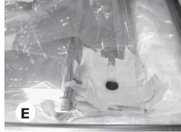
Um versehentliches Verschütten zu minimieren, bevor die Baugruppe in den Ofen eintritt, kleben Sie Klebeband (z. B. Kreppband) über die Oberseiten der Füllrohre und durchstechen Sie dieses mit einem kleinen Loch, damit der Dampf entweichen kann.
