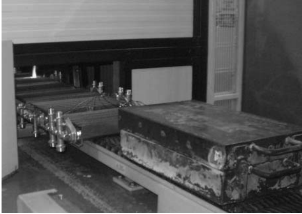
Hitzeschutzbehälter mit Thermoelementen am Teststück.
