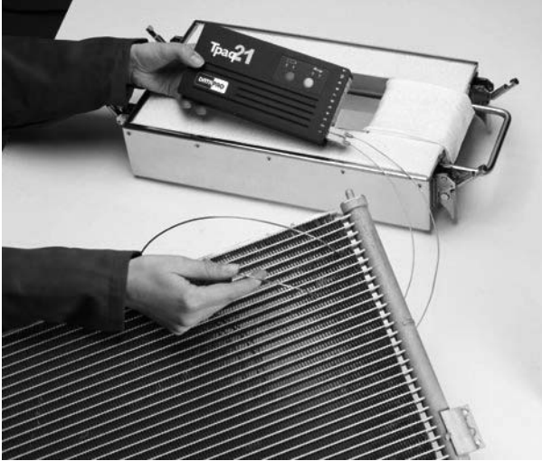
An einer Heizung angebrachte Thermoelemente.
