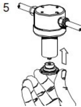
Abbildung 7 Wartung des Koaleszenzfilters 3
