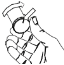
Abbildung 8 Wartung des Koaleszenzfilters 4
