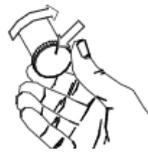
Das Filterrohr wird sicher abgedichtet, indem die Halterung des Filterelements nach dem ersten Kontakt mit dem Filterelement eine 1/4 bis eine Umdrehung gedreht wird. Die genaue Menge hängt vom Gehäusotyp und der Größe des Elements ab. Eine Markierung am Ende der Halterung wird zur Orientierung verwendet.
