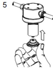
Einweg- und gesinterte PTFE-Filterelemente sind durch Verpressen gegen eine flache Oberfläche (5) abgedichtet worden. Dichtungen zwischen Filterelement und Gehäusekomponenten sind nicht erforderlich. Das Element wird mithilfe von Führungen an jedem Ende, die zum Innendurchmesser des Rohrs passen, korrekt positioniert.
