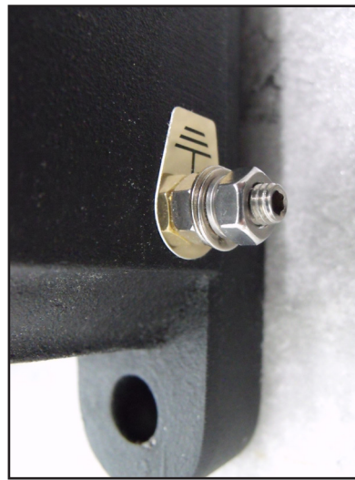
Abb 2 Erdanschlussbolzen und die dazugehörigen Befestigungskomponenten
