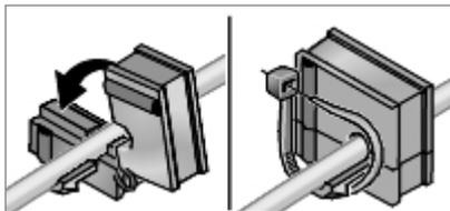
Leitung in passende Tülle einlegen und bei Bedarf mit Kabelbinder zugentlasten.
