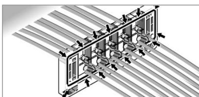
Die Tüllen müssen auf der Rückseite eine umlaufende Dichtung ergeben.
