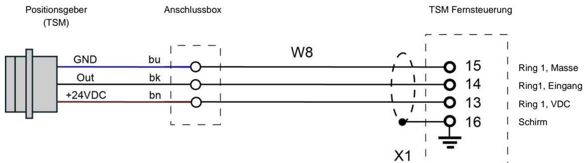
Tabelle 8-3: W8 – Vollständige Anschlussleistenverdrahtung für alle Positionsgeber
