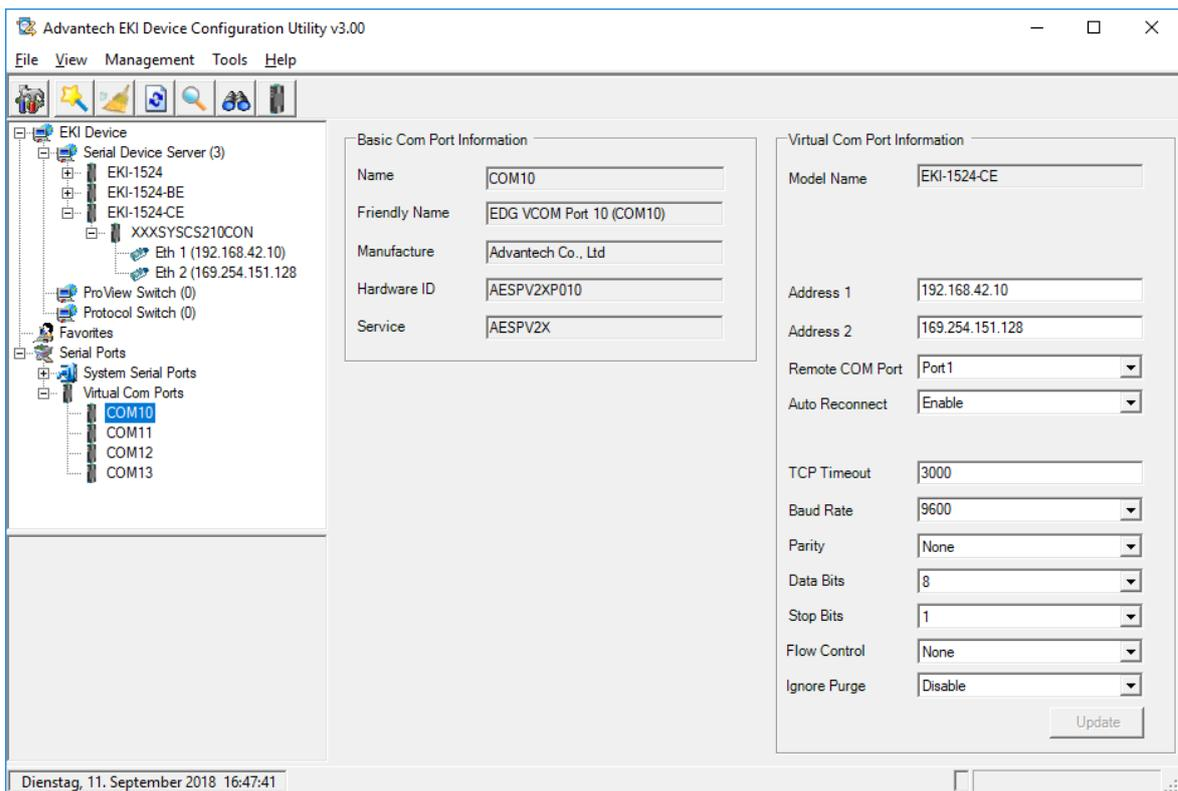
8. Die Konfiguration für die vier Ports des seriellen Geräts <XXSYSCS210CON> sind voreingestellt entsprechend den verfügbaren CS Zubehörteilen. So ist z.B. Port 2 konfiguriert als RS485 Schnittstelle zur Kommunikation mit den Schattenpyrometern, welche wiederum an der Schalteleiste X4 zu verdrahten sind. Im obigen Beispiel wurde Port 2 dem virtuellen COM Port 11 zugewiesen, welcher entsprechend in der CS Software Konfiguration einzustellen ist.
