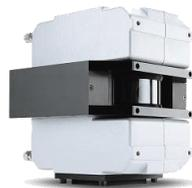
Das Kernstück des CS400 Systems ist ein Infrarot-Linescanner. Der Linescanner erfasst die Infrarotenergie, die von der Oberfläche des Ofens ausgestrahlt wird, wodurch das System die Temperatur über die gesamte Länge des Ofens messen kann.
