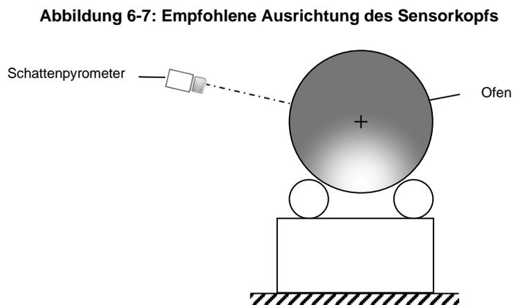
Es ist wichtig, dass der Sensor in einer geeigneten Entfernung zum Ofen montiert wird, damit immer der gewünschte Überwachungsbereich erfasst wird. Für diesen Zweck stellt der Hersteller einen Messfleck Rechner zur Verfügung, welcher die Größe des resultierenden Messflecks in Abhängigkeit von der Messentfernung und der verwendeten Optik berechnet, siehe
