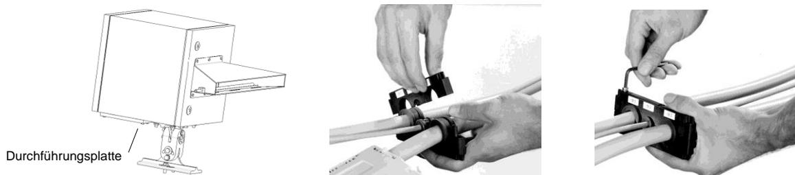
Befestigen Sie die Durchführungsplatte mit den 4 M5 x 25 Schrauben an der Außenseite des Schutzgehäuses. Stecken Sie die Kabelanschlüsse in den Linescanner und erden Sie das Gehäuse!
