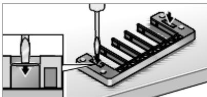
Abdeckungen am Grundrahmen mit geeignetem Werkzeug durchstoßen.
