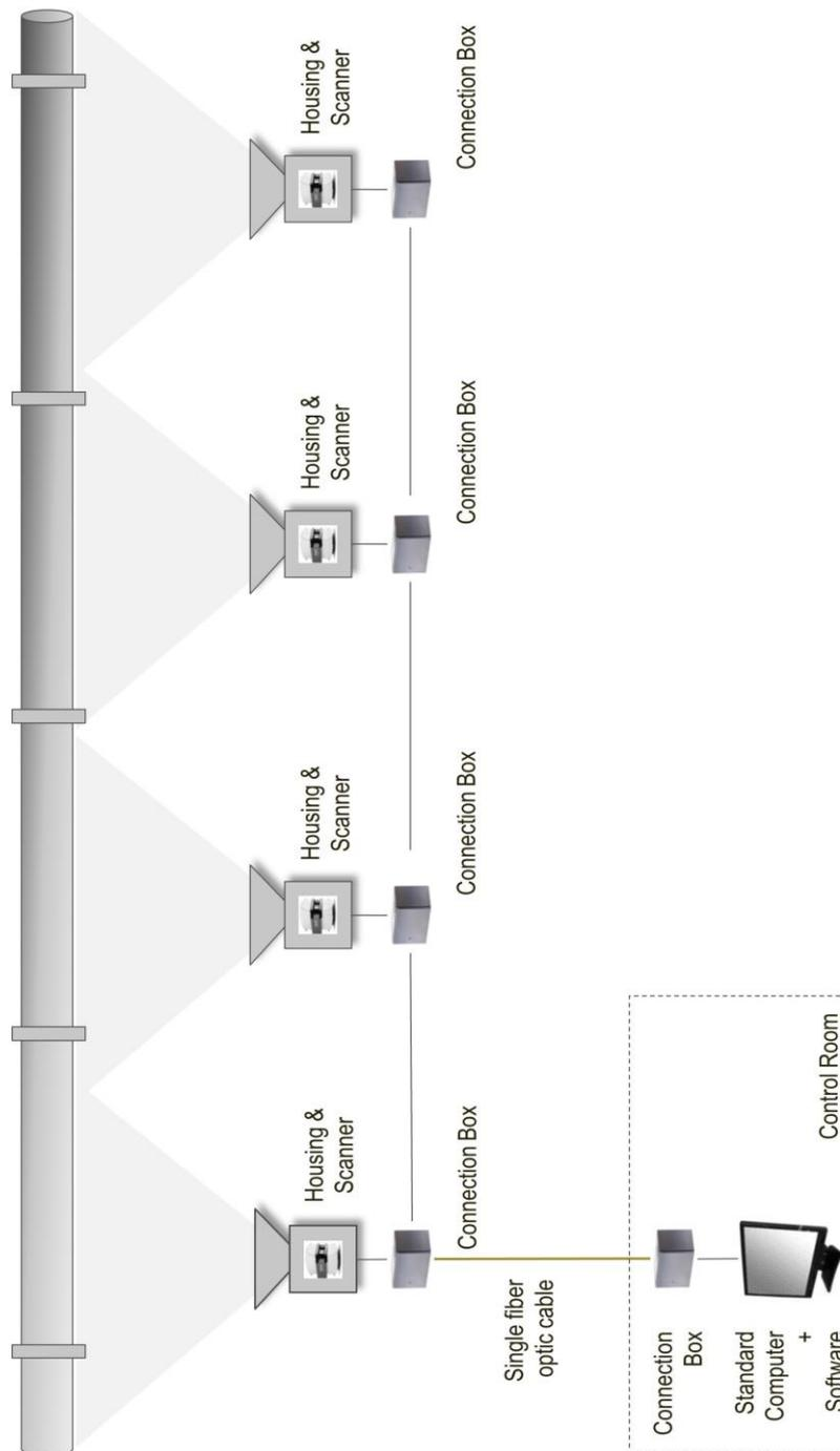
Die Übersicht zeigt den prinzipiellen Aufbau eines Systems mit 4 Scannern. Die konkrete Verdrahtung ist für jeden Scanner identisch. Der Positionsgeber für den Ofenrigger kann an jede der Anschlussboxen verdrahtet werden.
