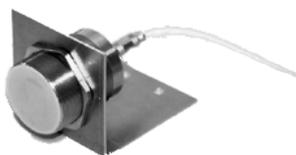
Der Positionsgeber besteht aus zwei Teilen: einem Hochtemperatur-Sensorkopf und einer Verbindungsbox. Da die höchste zulässige Umgebungstemperatur 230°C beträgt, kann der Sensor in der Nähe der Drehrohrofenoberfläche angebracht werden. Für die Anschlussbox ist eine maximale Umgebungstemperatur von 70°C zulässig. Weitere technische Informationen finden Sie im Anhang unter Abschnitt 9.5 [Positionsgeber](#), Seite 65.
