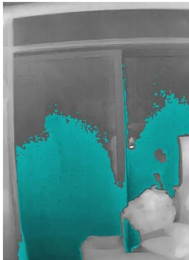
Dieser Modus ist für professionelle Benutzer gedacht, um Anomalien der Innenisolierung von Gebäudewänden und -decken zu erkennen. Zusätzliche Parameter wie **Innentemperatur**, **Außentemperatur** und **Isolationsstufe** sind erforderlich.
