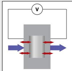
Der MSRS reagiert schnell auf Sauerstoff und hat eine T90 von unter 11 Sekunden. Durch die integrierte Referenz wird kein Referenzgas benötigt und die Messung ist unabhängig von der Qualität der Umgebungsluft. Der Analysator ist nahezu driftfrei, wodurch Kalibrierzyklen minimiert werden.
