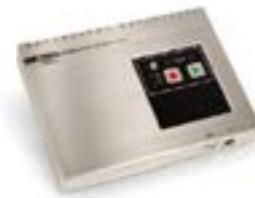
**TP6100:** 10 Anschlüsse für Thermoelemente und Unterstützung der breitesten Palette von Hitzeschutzbehältern, einschließlich unserer abgedichteten Produktreihe für Abschreckprozesse. Dieser Datenlogger kann mit verschiedenen Thermoelementen sowie mit einem Funksender bestellt werden, der Echtzeitprofildaten aus dem laufenden Prozess übermittelt.
