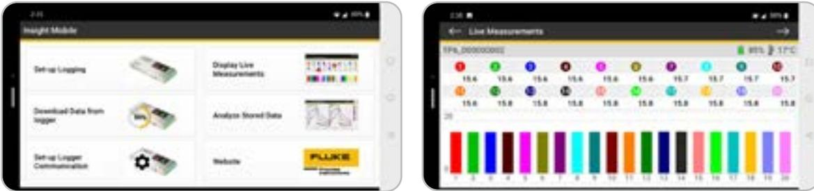
Mit der Insight for Mobile-App können Sie über ein mit Bluetooth verbundenes Tablet oder Smartphone den Datenlogger zurücksetzen, Thermoelemente überprüfen, Daten herunterladen und analysieren.
