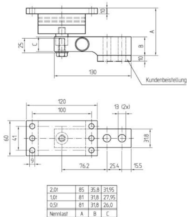
Alle Teile exakt waagrecht ausrichten und verspannungsfrei montieren!
