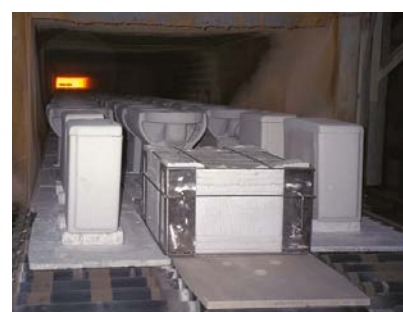
Kiln Tracker System im Rollenofen für Sanitärkeramik
