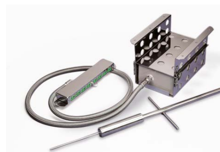
Hitzeschutzbehälter mit „Ofenantenne“
