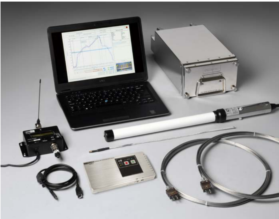
Kiln Tracker System mit Funktelemetriesystem TM21
