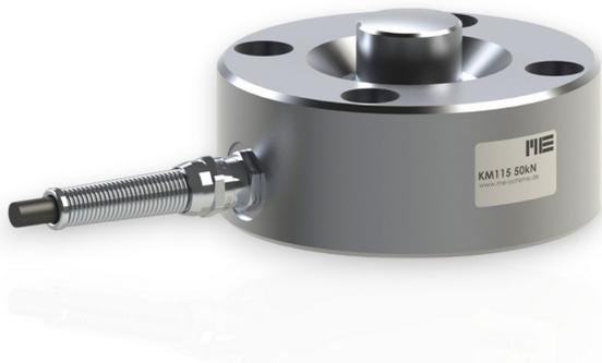
Der Kraftsensor KM115 ist ein Membran-Kraftsensor zur Messung von Druckkräften. Der Kraftsensor wird von der Unterseite mit vier Schrauben M12 auf einer ebenen Fläche befestigt.
