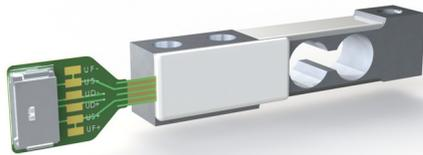
Der Kraftsensor KD60a dient als Nachfolger für den KD60-Kraftsensor. Er hat ebenfalls die Geometrie einer Miniatur-Wägezelle und wird über die Durchgangsbohrungen einseitig befestigt. Die Krafteinleitung erfolgt in das Gewinde M5. Die Krafteinleitung wird bei Belastung parallel verschoben. Verschiebungen der Krafteinleitung und Querkräfte toleriert der Kraftsensor aufgrund seiner Ausführung als Doppelbalken.
