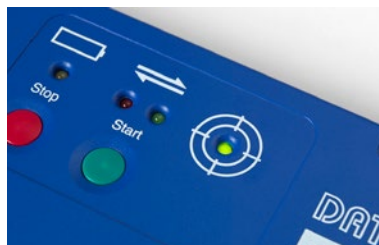
Logger ET3 mit SmartPaq* Gut/Schlecht-Anzeige auf dem Logger
