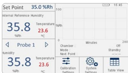
Auf einem 4,3-Zoll-LCD-Touchscreen läuft eine leistungsstarke Benutzeroberfläche, die alle Messwerte der Referenz und der zu prüfenden Fühler sowie eine grafische Trendanzeige der Kammerstabilität anzeigt. Das Gerät ist außerdem in der Lage, komplette Validierungsverfahren problemlos zu automatisieren und eine vollständige Protokollierung im csv-Format direkt auf Ihrem USB-Speichergerät bereitzustellen, um den Zeitaufwand für die Messwerterfassung zu minimieren.
