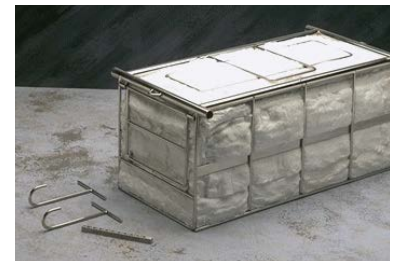
Furnace-Tracker-System für Walzblöcke
