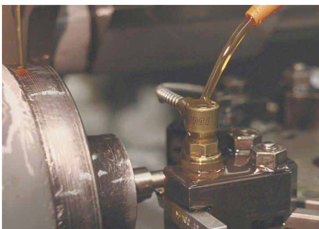
IMI 607A61 mit Swiveler®-Design und Kabel mit Schutzmantel eingetaucht in Schneidöl.
